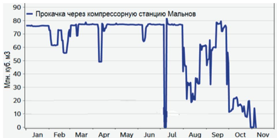
Рис. 5. Прокачка через компрессорную станцию Мальнов по трубе Ямал-Европа
